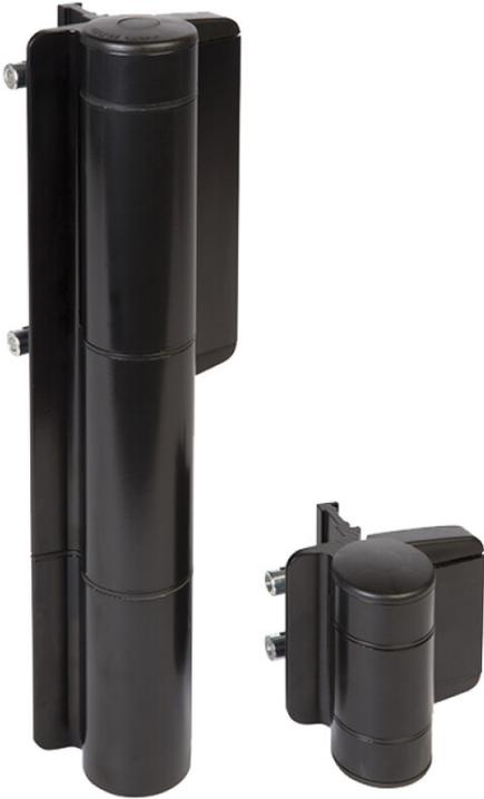
Charnière à fermeture automatique élégante et puissante avec ouverture à 180°. Le Mammoth est parfaitement adapté pour les portes d'un poids max de 150 kg et de largeur max 1500 mm. Il est équipé d'un double roulement pour une utilisation encore plus confortable. Le système d'amortissement hydraulique garantit une vitesse de fermeture constante insensible aux variations de température. La charnière basse DINO est incluse.
